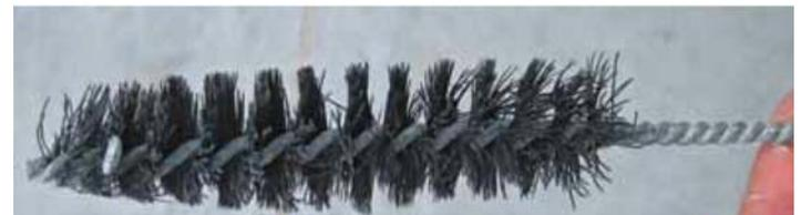
**Figure 8: Les écouvillons sont rarement utilisés sur les chantiers. Dans ce cas un écouvillon a été utilisé mais son efficacité n'est pas optimum vu sa vétusté. Les critères sur la vétusté des accessoires ne sont pas disponibles dans les instructions sur les chantiers.**
