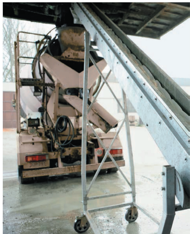
Fig. 1: El Dramix Booster es un aparato de transporte y dosificación completamente automático para las fibras de acero
