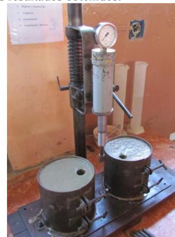
Imagen 1: Ensayo de Tiempo de Fragua.
