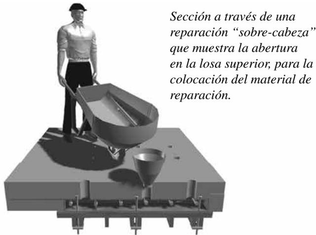
*Sección a través de una reparación “sobre-cabeza” que muestra la abertura en la losa superior, para la colocación del material de reparación.*
