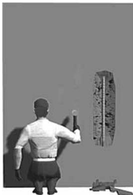
*Sondeo (mediante impactos con martillo u otro método) del concreto para localizar las áreas de delaminación.*
