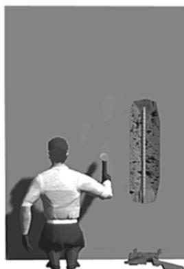
Sondeo del concreto para localizar las áreas de delaminación.
