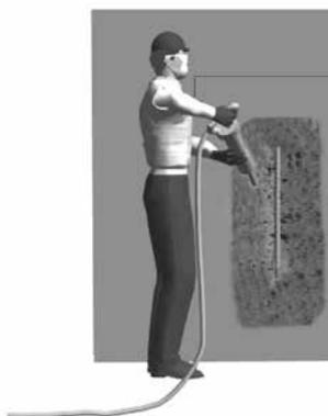
*Retiro del concreto dañado con un martillo cincelador de 7 kg (15 lb). Los martillos de más de 7 kg (15 lb), pueden dañar el sustrato y el refuerzo.*
