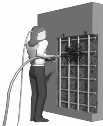
*Limpieza del acero de refuerzo y concreto con abrasivos proyectados.*
