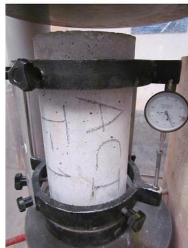
**Imagen 3: Equipo para ensayo de Módulo de Elasticidad.**
