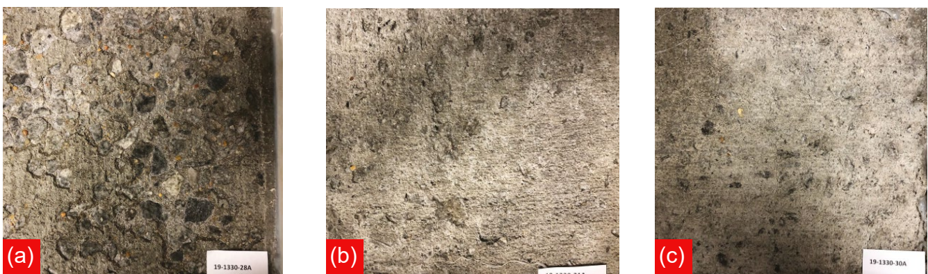
Fig. 6: Superficies de especímenes de concreto preparados con una relación a/c = 0,42 después de 50 ciclos de pruebas de descamación salina según ASTM C672/C672M: (a) concreto sin aire incluido; (b) concreto con aire incluido; y (c) concreto con microesferas
