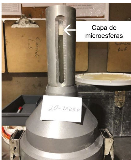
Fig. 7: El contenido de microesferas de una mezcla de concreto puede ser evaluado utilizando un medidor volumétrico
