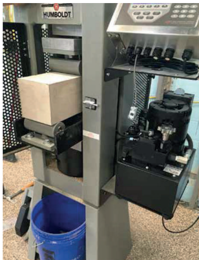
Fig.6: Configuración típica de la prueba de flexión según ASTM C78 / C78M
