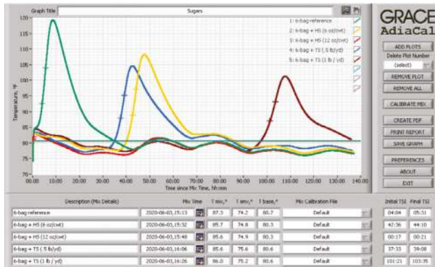
Figura. 2: Resultados de AdiaCal de los efectos de las adiciones de azúcar de mesa (TS) o estabilizador de hidratación (HS) en el desarrollo de temperatura en mezclas de mortero
