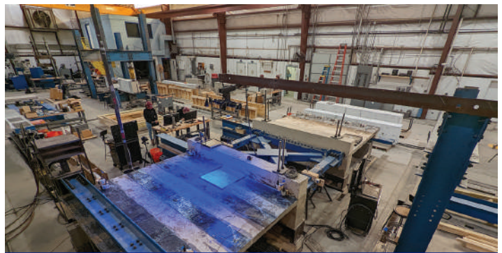
Las pruebas a gran escala demostraron que el refuerzo con FRP adherido externamente mejoraba significativamente tanto la resistencia al corte como la rigidez de los diafragmas de concreto reforzado con deficiencias estructurales.
