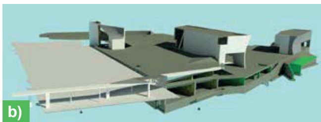
Fig. 1: Las características exteriores prominentes del REACH en el Kennedy Center incluyen tres pabellones y una pasarela cubierta: (a) una vista aérea muestra los pabellones (primer plano derecho) en relación con el edificio original del Kennedy Center (primer plano izquierdo); y (b) una representación del modelo de información de construcción de concreto (desde la izquierda: el Welcome Pavilion, el Skylight Pavilion y el River Pavilion) (imágenes cortesía de: (a) el Kennedy Center; y (b) Scott Hover, previamente gerente de BIM en Construcción de carril)
