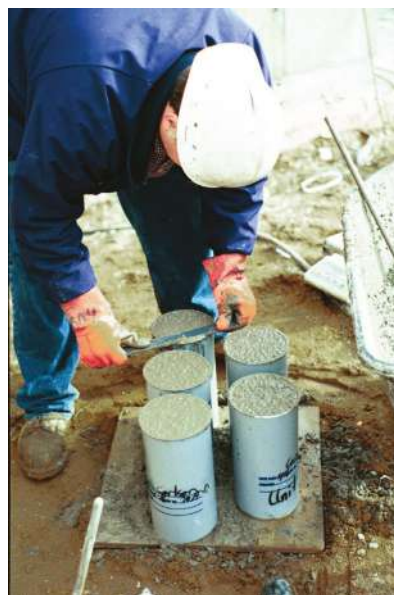
Figura. 1: Normalmente, se fabrican de cuatro a seis cilindros de concreto de 6 x 12 pulg. en la obra para cumplir con los requisitos de las especificaciones del proyecto (foto cortesía de PCA)
