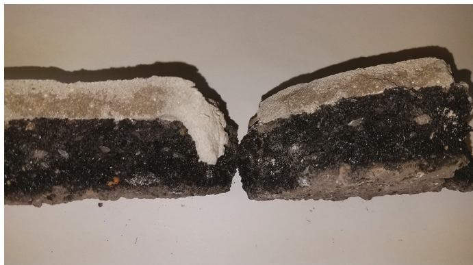
Figura.2: Una capa de X-PHALT sobre asfalto. La muestra fue sometida a flexión y se fracturó sin mostrar delaminación.
