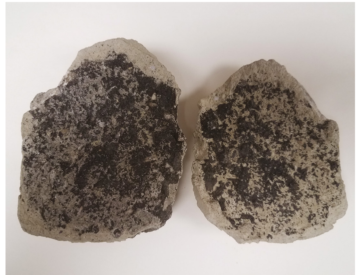
Figura.3: Reparación de asfalto con X-PHALT. La muestra fue sometida a cortante en la interfaz, exhibiendo falla por extracción, lo que indica buena adherencia.
