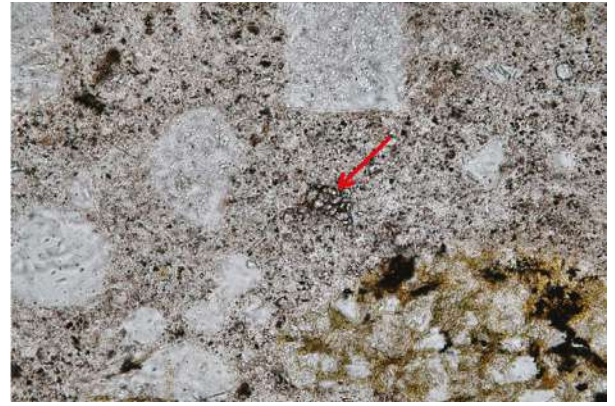
Fig. 6: Micrografía de sección delgada de hormigón CBSA endurecido, tomada utilizando una fuente de luz de polarización simple. El campo de visión es de 0.03 pulgadas (0.76 mm) de ancho. Se observa una hidratación casi completa. La flecha roja indica un rastro de cemento sulfoaluminato de calcio residual en la pasta
