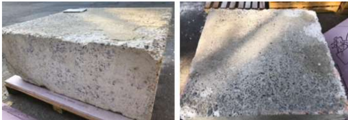
Fig. 1 Muestra de losa CBSA de la pista, tomada después de 23 años de servicio
