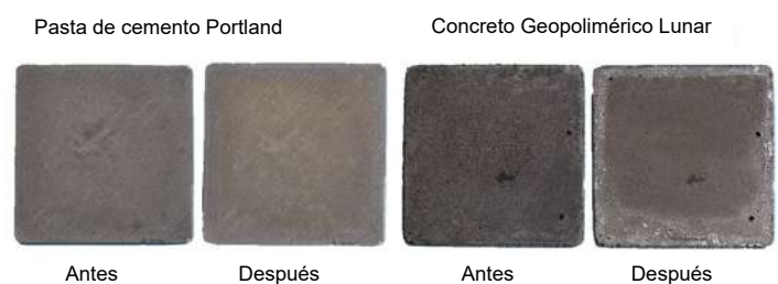
Fig. 3: Muestra de pasta de cemento portland y muestra de concreto geopolimérico lunar antes y después de la exposición fuera de la ISS en la dirección cenital
