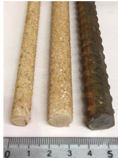
Fig. 3: Tipos de varillas utilizadas en el estudio, de izquierda a derecha: Varillas de GFRP #3 y #4 y varilla de acero #4.
