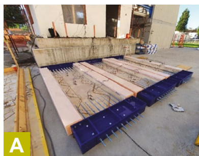
Fig. 1: Detalles del montaje de las losas: (a) cimbras de acero con película plástica antifricción, separadores o silletas tipo "serpiente" y varillas de anclaje roscadas (desde la izquierda, en exposición interior y exterior); y (b) especímenes después del colado (desde la izquierda, en exposición interior y exterior).
